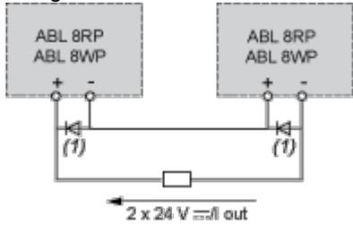
(1) Due diodi Shottky  $I_{min}$  = alimentatore  $I_n$  e  $V_{min}$  = 50 V
