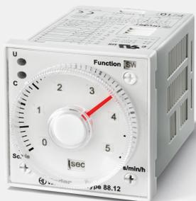
**Descrizione tecnica:** Temporizzatore da innesto, Multifunzione, 2 contatti, 8 A, Bobina AC/DC, 230 V, funzionamento da 20.4 a 264.5 V (AC)/(DC), potenza nominale 2.5 VA (AC) / 1.5 W (DC), temperatura ambiente da -10 a +55 °C
