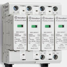
**Descrizione tecnica:** Scaricatore di sovratensione, Tipo 2, 4 varistori, Indicazione remota: senza contatto di segnalazione remota, Corrente nominale: 20 kA, Tipo di alimentazione AC, tensione di alimentazione nominale 275 V, temperatura ambiente da -40 a +80 °C
