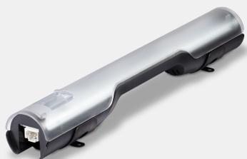
**Descrizione tecnica:** Lampada LED-1200 lumens, Tipo di alimentazione AC/DC, tensione di alimentazione nominale 230 V, funzionamento da 9.6 a 52.8 V (AC) e da 88 a 264 V (DC), potenza nominale 9 VA, Accensione: tramite pulsante ON / OFF, Connessioni: terminali Push-in per la connessione di una singola lampada, temperatura ambiente da -30 a +55 °C
