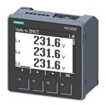
SENTRON PAC3220 LCD 96x96 mm Power Monitoring Device apparecchio da incasso in pannello di comando per la misura di grandezze elettriche protocollo: Modbus TCP con display grafico UE nom: 690/400V 45 ... 65 Hz IE nom: X/1A oppure X/5A AC energia ausiliaria: DC 24 ... 60 V -20/+10 % collegamento con morsetti a vite
