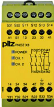
Modulo di sicurezza (standalone), ingressi: Cablaggio mono/bicanale con/ senza rilevamento del cortocircuito, uscite: 3 NO, 1 NC, 1semiconduttore, start automatico/controllato, UB 110 V AC/24 V DC, larghezza: 45 mm, morsetti a vite integrati, controllo arresto di emergenza, riparabili.
