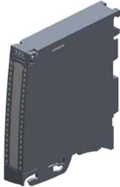
SIMATIC S7-1500, modulo di ingressi analogici AI 4xU/I/RTD/TC ST, risoluzione 16 bit, precisione 0,3 %, 4 canali in gruppi da 4, 2 canali per misura RTD, tensione di modo comune 10V; diagnostica; interrupt di processo; fornitura compresa di un connettore frontale push-in, elemento di alimentazione, staffa per schermo, e morsetto dello schermo
