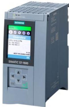
SIMATIC S7-1500, CPU 1515-2 PN, unità centrale con memoria di lavoro 500 KB per programma e 3 Mbyte per dati, 1ª interfaccia: PROFINET IRT con switch a 2 porte, 2ª interfaccia: PROFINET RT, performance a bit di 30 ns, SIMATIC Memory Card necessaria
