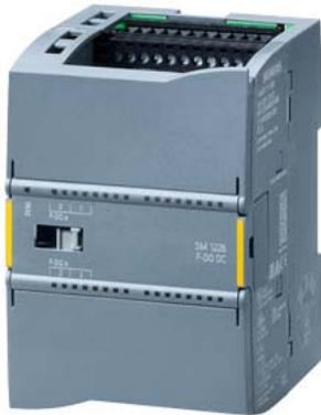
SIMATIC S7-1200, unità di uscite digitali SM 1226, F-DQ 4x DC 24V 2A, PROFIsafe, Larghezza costruttiva 70mm, fino a PL E (ISO 13849-1)/ SIL3 (IEC 61508)
