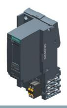
SIMATIC ET 200SP, PROFINET, modulo d'interfaccia a 2 porte IM 155-6PN/2 High Feature, 1 posto connettore per BusAdapter, max. 64 moduli di periferia e 16 moduli ET 200AL, ridondanza S2, Multi Hot Swap, 0,25 ms, funzionamento con sincronismo di clock, scarico di tiro PN opzionale, incl. modulo server
