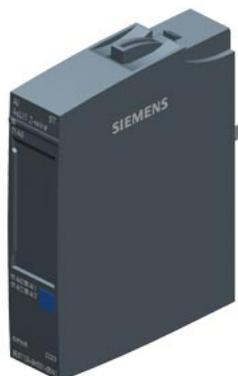
SIMATIC ET 200SP, Modulo di ingressi analogici, AI 4XU/I a 2 fili standard, Quantità di pezzi nell'imballo 1 pezzo adatto per BU tipo A0, A1, Codice colore CC03, Modulo diagnostica, 16 bit, +/-0,3%
