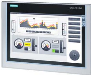
SIMATIC HMI TP1200 Comfort, Comfort Panel, comando touch, display TFT widescreen da 12", 16 milioni di colori, interfaccia PROFINET, interfaccia MPI/PROFIBUS DP, memoria di progettazione 12 Mbyte, Windows CE 6.0, progettabile da WinCC Comfort V11
