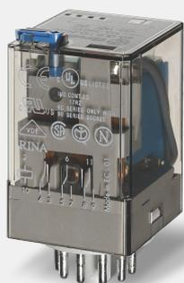
**Descrizione tecnica:** Relè industriale, Ad innesto su zoccolo octal o undecal, 3 contatti, Scambio, 10 A, AgNi, Bobina DC, 24 V, funzionamento da 19.2 a 26.4 V, potenza nominale 1.3 W, resistenza 445 Ω, assorbimento 53.9 mA, tensione di mantenimento 12 V, tensione di rilascio 2.4 V, variante: Pulsante di prova + indicatore meccanico, temperatura ambiente da -40 a +70 °C
