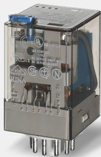
**Descrizione tecnica:** Relè industriale, Ad innesto su zoccolo octal o undecal, 3 contatti, Scambio, 10 A, AgNi, Bobina AC, 12 V, funzionamento da 9.6 a 13.2 V, potenza nominale 2.2 VA, resistenza 19 Ω, assorbimento 183 mA, tensione di mantenimento 9.6 V, tensione di rilascio 2.4 V, variante: Pulsante di prova + indicatore meccanico, temperatura ambiente da -40 a +70 °C
