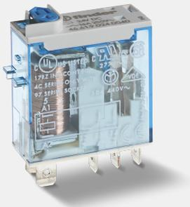
**Descrizione tecnica:** Mini relè industriale, Terminali da innesto/terminali Faston, 1 contatto, Scambio, 16 A, AgNi, Bobina DC, 12 V, funzionamento da 8.8 a 13.2 V, potenza nominale 0.5 W, resistenza 300 Ω, assorbimento 40 mA, tensione di mantenimento 4.8 V, tensione di rilascio 1.2 V, variante: Pulsante di prova + indicatore meccanico, temperatura ambiente da -40 a +70 °C
