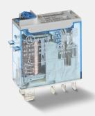
Descrizione tecnica: Mini relè industriale, Terminali da innesto/terminali Faston, 1 contatto, Scambio, 16 A, AgNi, Bobina AC, 12 V, funzionamento da 9.6 a 13.2
