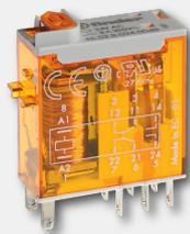
**Descrizione tecnica:** Mini relè industriale, Terminali da innesto/a saldare, 2 contatti, Scambio, 8 A, AgNi, Bobina DC, 24 V, funzionamento da 17.5 a 26.4 V, potenza nominale 0.5 W, resistenza 1200 Ω, assorbimento 20 mA, tensione di mantenimento 9.6 V, tensione di rilascio 2.4 V, variante: Pulsante di prova + indicatore meccanico, temperatura ambiente da -40 a +70 °C
