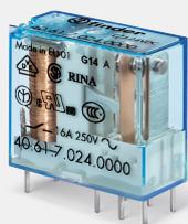
**Descrizione tecnica:** Mini relè, Circuito stampato - Passo 5 mm, 1 contatto, Scambio, 16 A, AgCdO, Bobina AC, 12 V, funzionamento da 9.6 a 13.2 V, potenza nominale 1.2 VA, resistenza 80 Ω, assorbimento 90 mA, tensione di mantenimento 9.6 V, tensione di rilascio 2.4 V, variante: Lunghezza pin 5.3 mm (innesto su zoccolo), versione: A prova di flussante (RT II), temperatura ambiente da -40 a +85 °C
