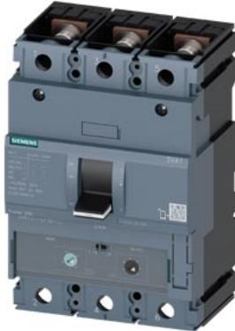
interruttore automatico 3VA1 IEC frame 250 classe del potere di interruzione S Icu=36kA con 415V a 3 poli, protezione impianto TM240, ATAM, In=250A protezione da sovraccarico Ir=175A...250A protezione da cortocircuito li=5...10 x In attacchi piatti a vite
