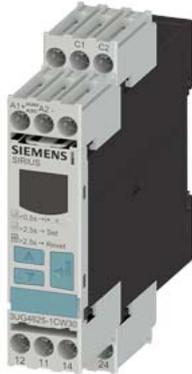
Relè di controllo digitale per il controllo della corrente di guasto (con trasformatore di corrente 3UL23) Campo di regolazione 0,03...40 A con separazione per soglia di avviso e valore di disinserzione tensione di alimentazione AC/DC 24...240V, 50 .. 60Hz avviamento e ritardo di intervento 0,1 ... 20 s isteresi di disinserzione fino a 50% isteresi di avviso 5% fisso Larghezza 22,5 mm, 2 contatti CO con o senza memorizzazione errore morsetto a vite
