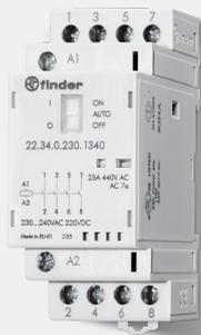
**Descrizione tecnica:** Contattore modulare, 25 A, 4 contatti, NO, 25 A, AgSnO2, Bobina AC/DC, 24 V, funzionamento da 19.2 a 26.4 V (AC)/(DC), potenza nominale 2 VA (AC) / 2.2 W (DC), tensione di mantenimento 9.6 V (AC)/(DC), tensione di rilascio 2.4 V (AC)/(DC), variante: Selettore manuale + indicatore meccanico + LED, temperatura ambiente da -25 a +50 °C
