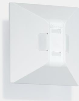
**Descrizione tecnica:** Rilevatore di movimento e presenza, di movimento da parete, 1 interruttore unipolare, 10 A, Programmazione: standard, Circuito contatti: contatto libero da potenziale (contatto pulito), Tipo di alimentazione AC, tensione di alimentazione nominale 230 V, funzionamento da 96 a 253 V, potenza nominale 1.5 VA, temperatura ambiente da -10 a +50 °C
