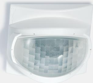
**Descrizione tecnica:** Rilevatore di movimento e presenza, per corridoio, 1 interruttore unipolare, 10 A, Programmazione: standard, Circuito contatti: contatto libero da potenziale (contatto pulito), Tipo di alimentazione AC, tensione di alimentazione nominale 230 V, funzionamento da 96 a 253 V, potenza nominale 1.5 VA, temperatura ambiente da -10 a +50 °C
