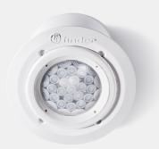
Descrizione tecnica: Rilevatore di movimento e presenza, Installazione da interni - montaggio ad incasso o a controsoffitto, 1 interruttore unipolare, 10 A, Programmazione: standard, Circuito contatti: contatto a potenziale di rete, Tipo di alimentazione AC, tensione di alimentazione nominale 230 V, funzionamento da 96 a 253 V, potenza nominale 2 VA, temperatura ambiente da -10 a +50 °C
