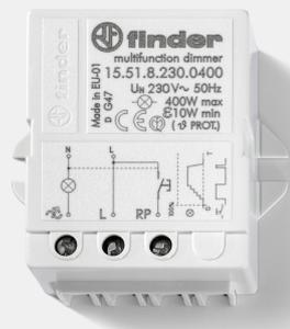
**Descrizione tecnica:** Varialuce (Dimmer), Montaggio a pannello o da incasso, 1 contatto, Tipo di alimentazione AC, tensione di alimentazione nominale 230 V, funzionamento da 0.8 a 1.1 V, Potenza commutabile 400 W, Frequenza di alimentazione AC: 50 Hz, temperatura ambiente da -10 a +50 °C
