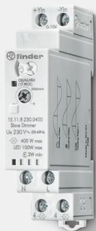
**Descrizione tecnica:** Varialuce (Dimmer) - Slave, montaggio su barra 35 mm (EN 60715), larghezza un modulo 17.5 mm, Tipo di alimentazione AC, tensione di alimentazione nominale 230 V, funzionamento da 0.8 a 1.1 V, temperatura ambiente da -10 a +50 °C
