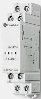
**Descrizione tecnica:** Relè elettronico, Bistabile modulare, fissaggio su barra 35 mm (EN 60715), larghezza 17.5 mm, 1 Contatto CO + 1 NO, 8 A, Tipo di alimentazione AC/DC, tensione di alimentazione nominale 24 V, funzionamento da 0.8 a 1.1 V (AC)/(DC), potenza nominale 3 VA (AC) / 2.5 W (DC), AgCdO, Circuito contatti: scambio + NO, temperatura ambiente da -10 a +60 °C
