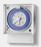
Descrizione tecnica: Interruttore orario, Diario o Semanal, 72 x 72 mm, 1 Scambio, 16 A, Tipo di alimentazione AC, tensione di alimentazione nominale 230 V, funzionamento da 0.85 a 1.1 V, potenza nominale 2 VA, Opzione: con riserva di carica, Opzione: giornaliero, temperatura ambiente da -10 a
